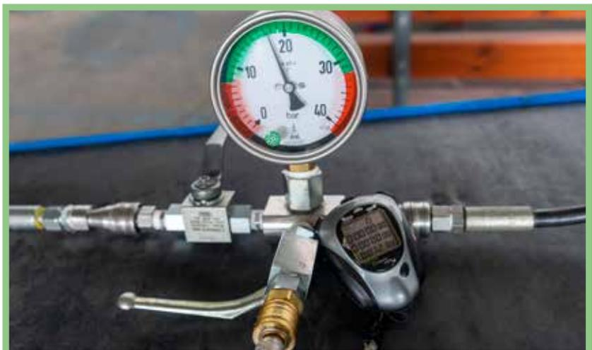
H<sub>2</sub>-Prüfung mit Wasser am ASR Absperrschieber    H<sub>2</sub>-Druck- und Zeit-Messung
